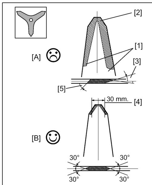
Снимите режущий орган, который следует заточить, и проверьте, нет ли на нем трещин, потери формы, деформаций.
